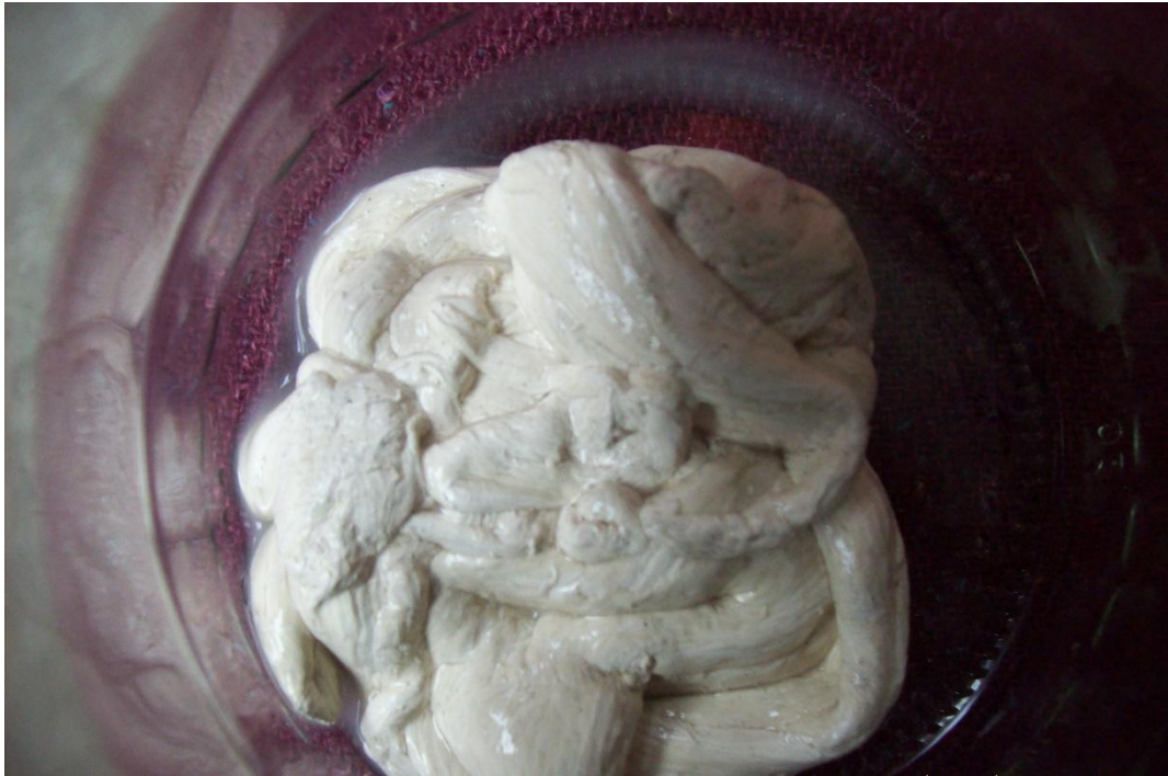
Pastöser sulfid-haltiger Schleim Frei von Eisen, angetroffen in den MPPE-Anlagen und im Brunnen der HABAUER-Anlage (Westabstrom) - 2009
